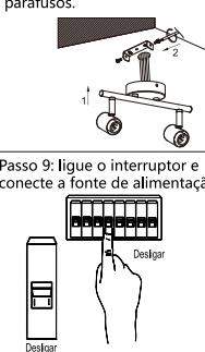
Passo 9: ligue o interruptor e conecte a fonte de alimentação.
