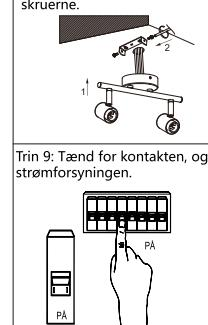
Trin 9: Tænd for kontakten, og tilslut strømforsyningen.
