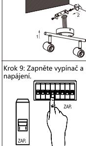
Krok 9: Zapněte vypínač a připojte napájení.
