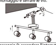
Passaggio 8: Montare il paralume sul portalampe e successivamente inserire la lampadina nel portalampe. Assicurarsi che la potenza della lampadina non superi i 40 W.
